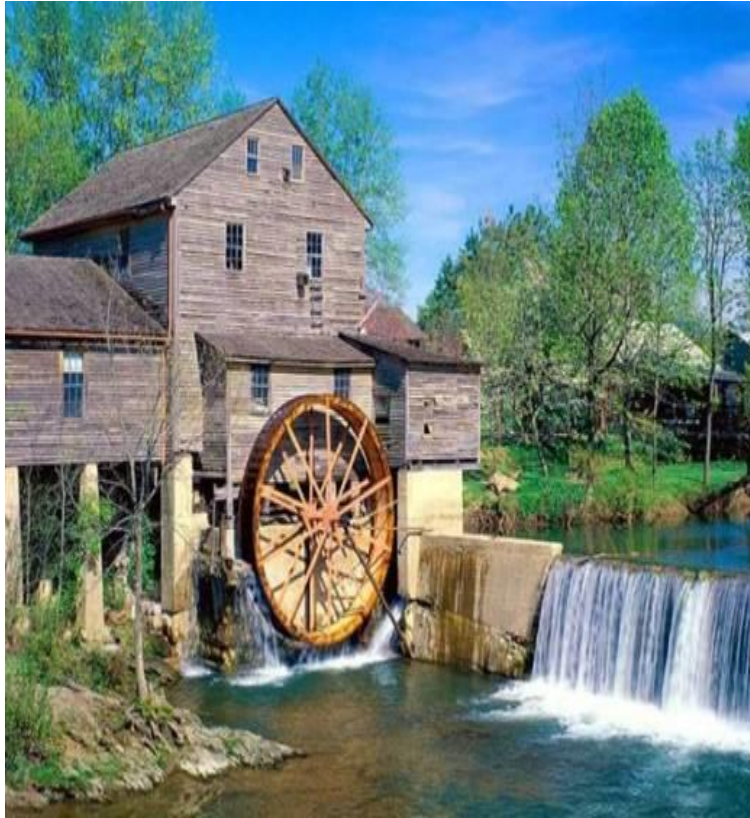
Водяная мельница с подливным колесом. Вода из плотины попадает на колесо снизу. Фото с сайта: http://namonitore.ru/wallpaper...
